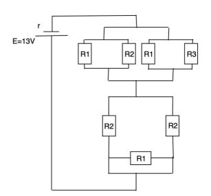
5. Soit le circuit électrique suivant : calculer la résistance équivalente du circuit et l'intensité I1 (en rose) :
