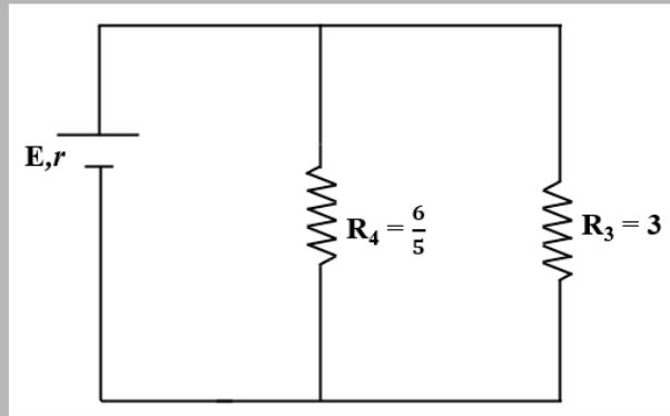
Après simplification du circuit, voici ce que l'on obtient (image ci-dessus). On remarque que l'on retombe encore une fois sur un circuit en parallèle. On effectue alors la même procédure. On appellera  $R_5$  la résistance équivalente de  $R_3$  et  $R_4$ .
